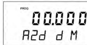
Alarme 2. Point de désactivation
