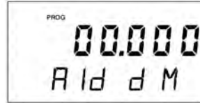
Alarme 1. Point de désactivation
